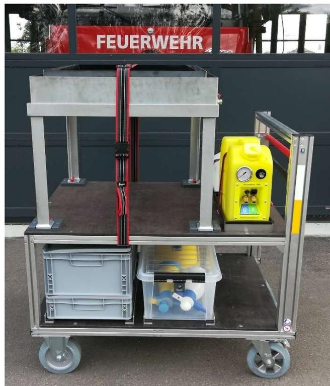
Das System beinhaltet alle für einen Schaumeinsatz notwendigen Einsatzmittel und Gerätschaften, wie Pumpaggregat, Schläuche und Schaumrohre in einem verkleinerten Maßstab. Zudem sind zur Realisierung eines Flüssigkeitsbrandes neben einem Gestell mit Auffangwanne auch noch verschiedene Brandwannen vorhanden.
